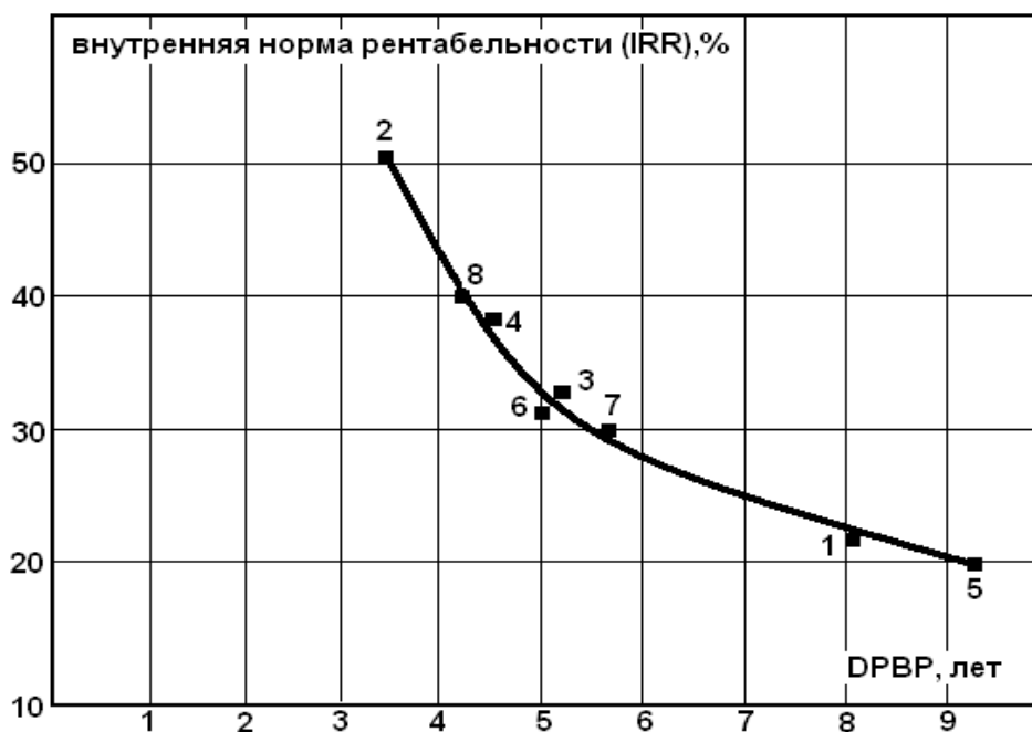
Рис. 5. Взаимосвязь между дисконтируемым сроком окупаемости (DPBP) комплекса ВТПК и внутренней нормой рентабельности (IRR). Цифрами указаны виды ОПП в соответствии с рис. 2.
